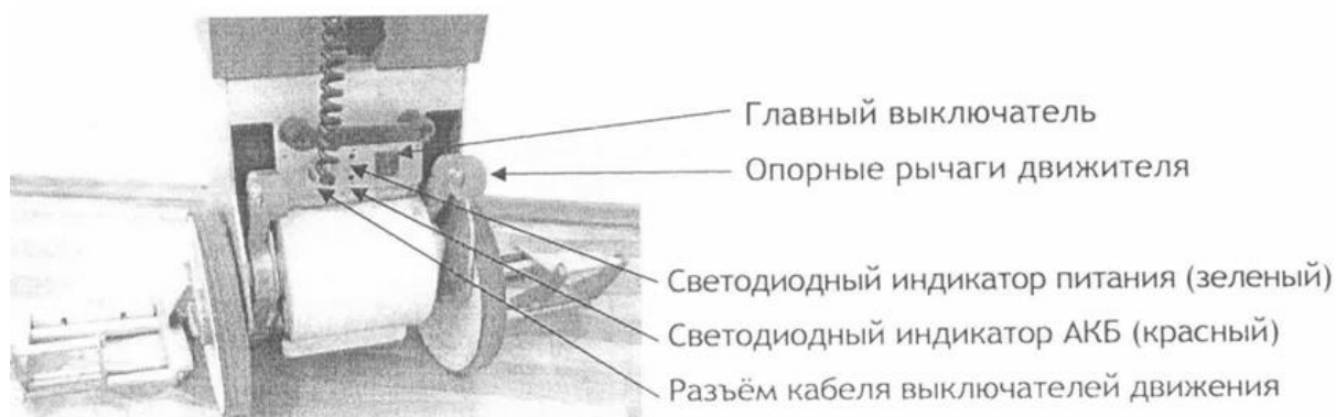
Рис.6. Элементы системы управления
