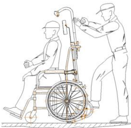
Рис.7. Установка кресла-коляски на подъемник
