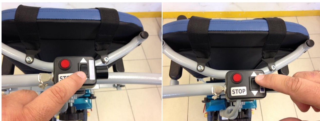
Рис.6.6 Кнопка переключателя движения вверх/вниз
