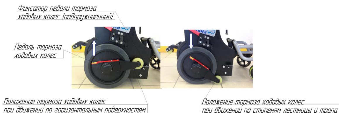
Рис.8 Тормоз ходовых колес
