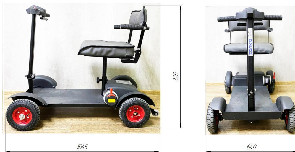
Рис. 1.1 Габаритные размеры электроскутера
