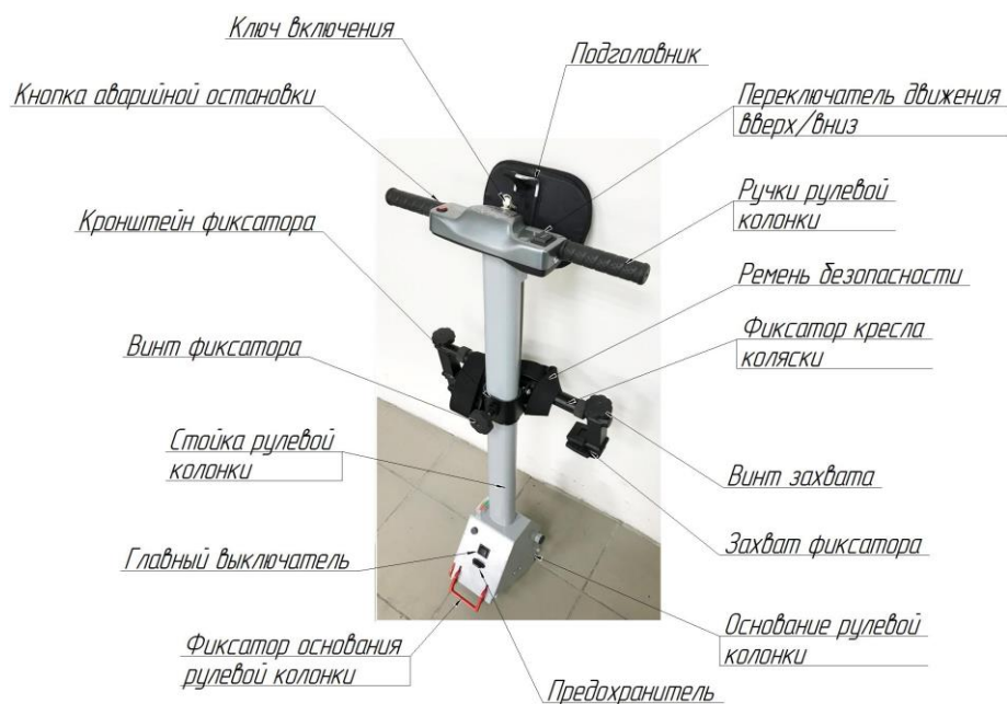
Рис.19. Рулевая колонка с фиксатором кресла-коляски
