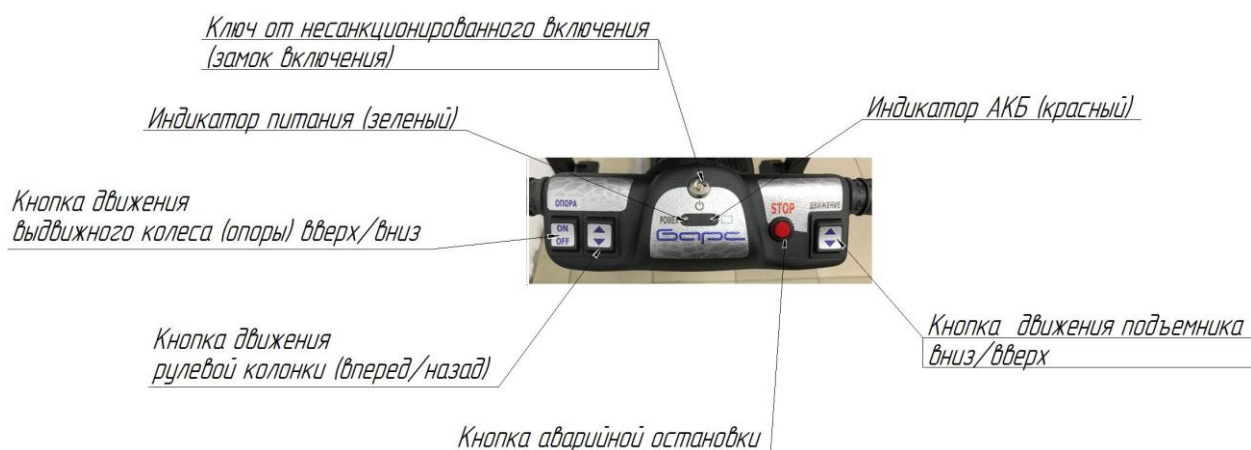
Рис.6а. Элементы системы управления на панели приборов
