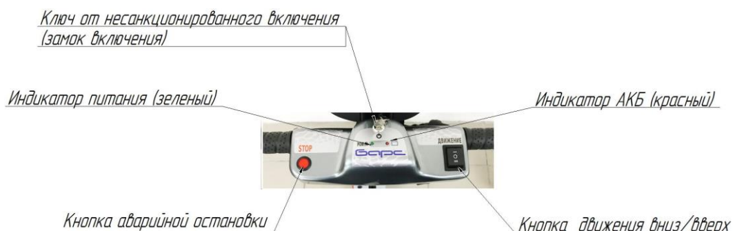
Рис.6а. Элементы системы управления на панели приборов
