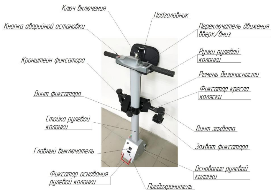
Рис.4. Рулевая колонка с основанием
