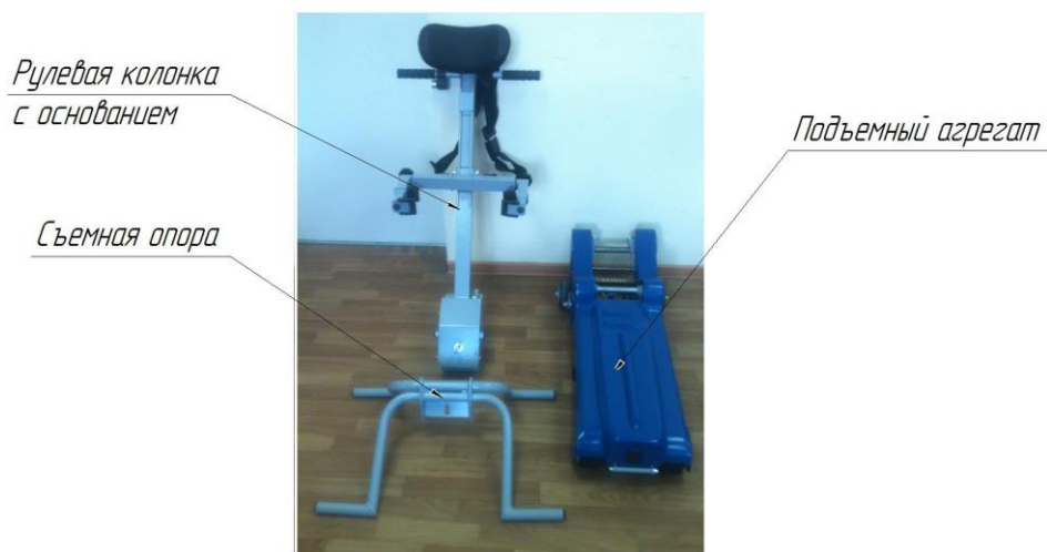
Рис.7. Составные части подъемника
